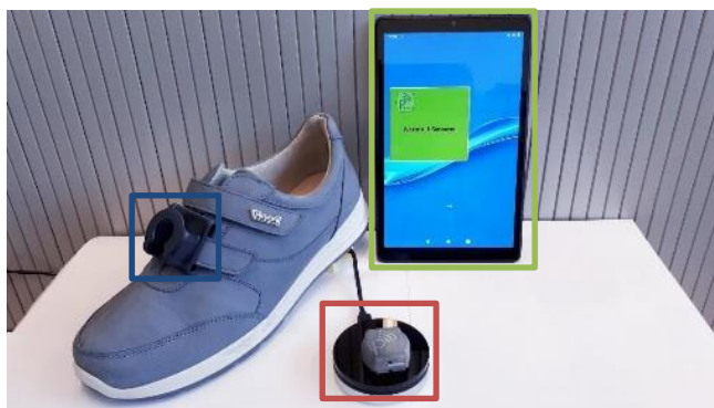
Studiensystem: Sensor mit Ladeplatte (rot), Sensor-Clip (blau) für die Befestigung am Schuh, Tablet-Computer (grün).
